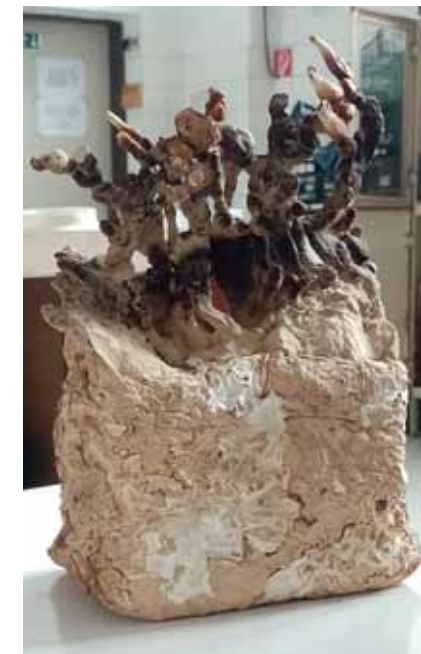
↑ Mycéliová tvárnica s vyrastenými hribkami.
