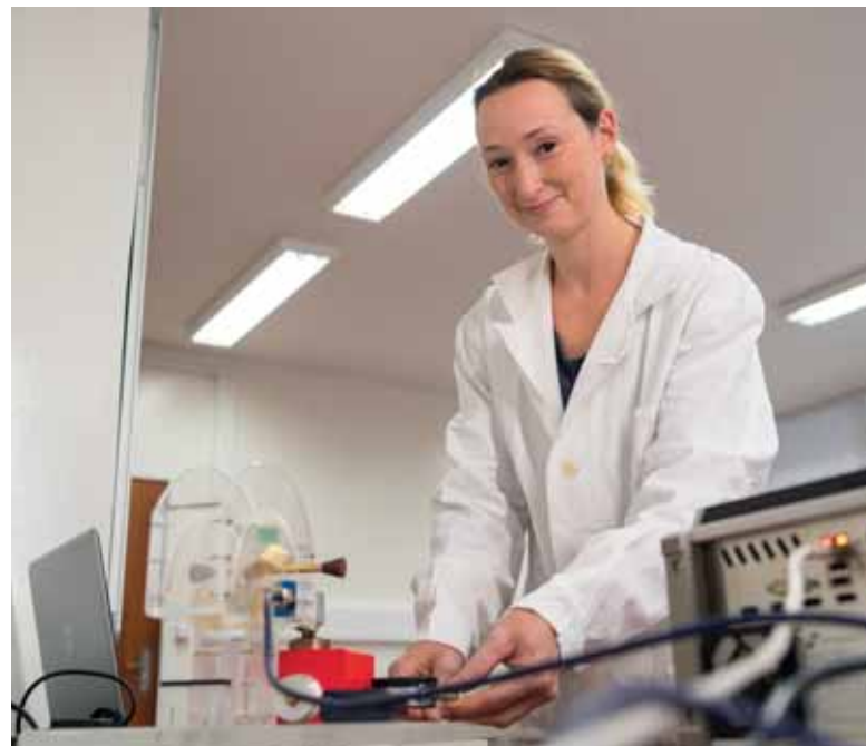
↑ Zakladanie vzorky ocele do meracej aparatúry Barkhausenovho šumu aplikovaného pre výskum reziduálnych napätí a štruktúrnych deketov.
