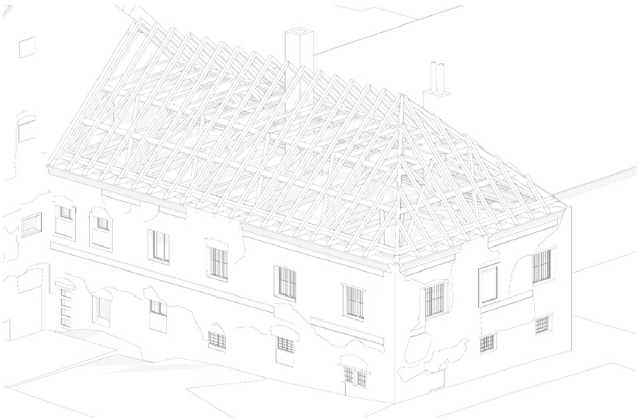
Obr. 4.: Axometria skutočného stavu riešeného kridla vymodelovaného v BIM (Zdroj: Ema Ruhigová, Roman Ruhig)
