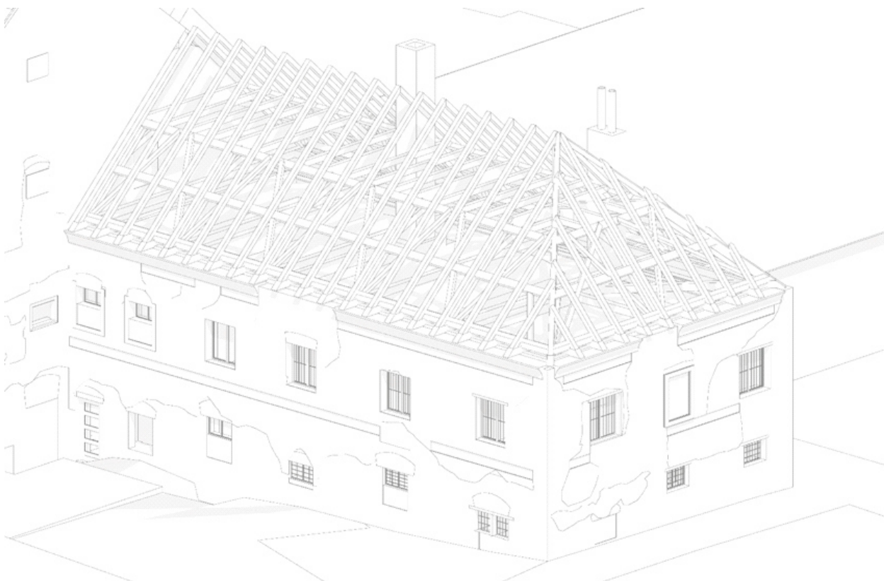
Obr. 4.: Axonometria skutočného stavu riešeného kridla vymodelovaného v BIM (Zdroj: Ema Ruhigová, Roman Ruhig)
